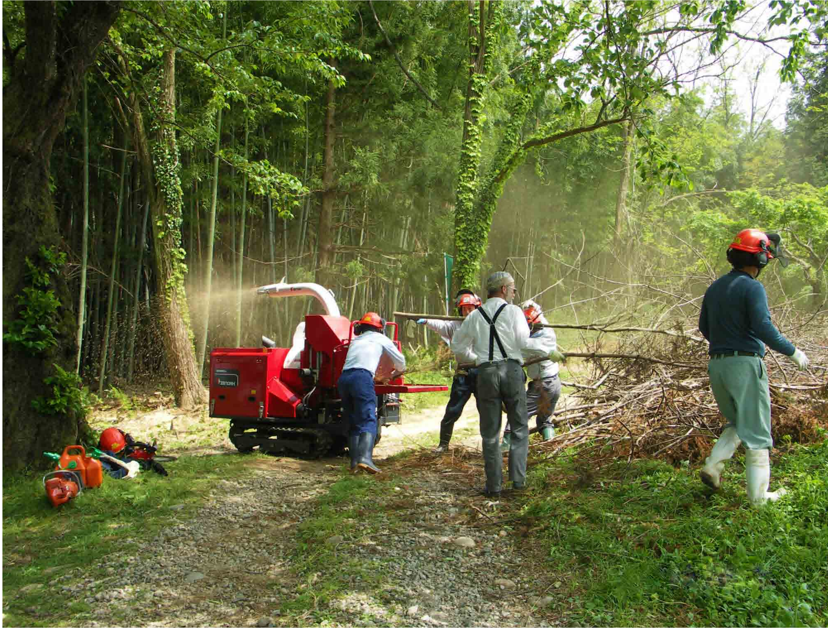
チップパー機による竹の粉碎作業
