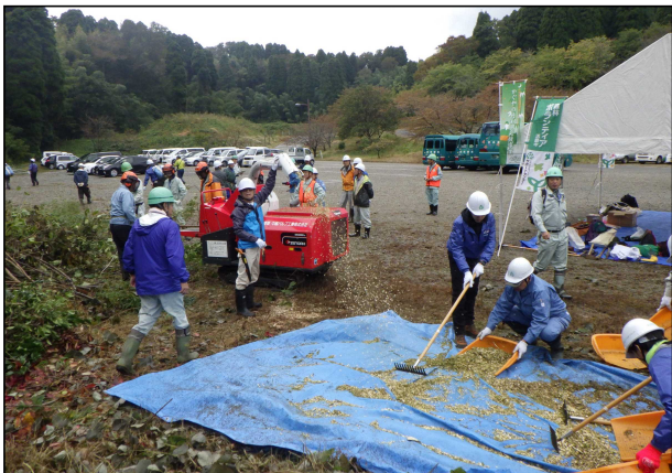
伐採した竹をチップper機にてチップ化
