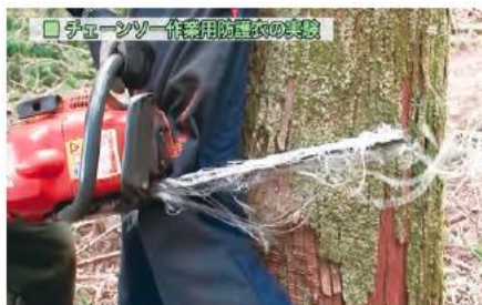
チェーンソー作業用防護衣の実験
