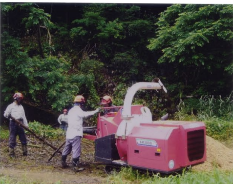
伐採竹を粉碎処理しています
